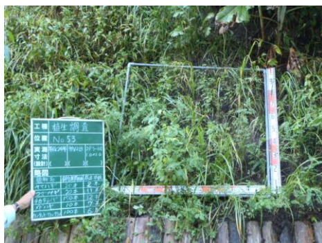
写真-1 チカラシバ種子を使用し緑化した法面
