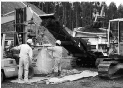
現場発生木材をチップに（徳島県 SF 緑化工法協会の事例）
