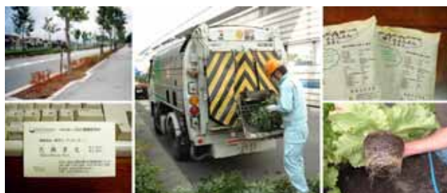
写真 整枝剪定屑の加工と枝葉の利用例（左上：枝のマルチ，左下：枝の名刺，中：車載型粗破碎機による収集と粗破碎，右上：葉の土壌改良材，右下：葉の園芸用培土）
