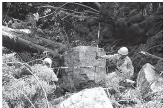
図3 スギ林が岩石の移動を抑止 ・下部のスギ林が岩石の移動を抑止 ・転石の大きさは最大3m
